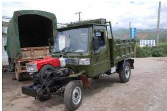
Zwischen Motor und Getriebe hat es Keilriemen, so kann der Motor überall längs oder quer eingebaut werden. Bei den Lastwagen und Omnibusse sieht man den Fortschritt am deutlichsten, neben noch vielen alten Fahrzeugen mit noch riesigen Benzinmotoren, sieht man vermehrt doch schon moderne Fahrzeuge mit gefederten Fahrerhäusern, modernen Kabinen- ABS (Antiblockier Systeme) und starken Dieselmotoren. Omnibusse sind oft schon Luftgefedert und haben durchaus europäischen Komfort.
